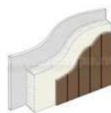
Isolation thermique thermo-guard sur cuve et jupe
